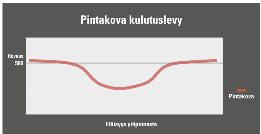
Kuva 3: Pintakovan levyn kovuuskäyrä. Levy on pehmeätä keskeltä.
