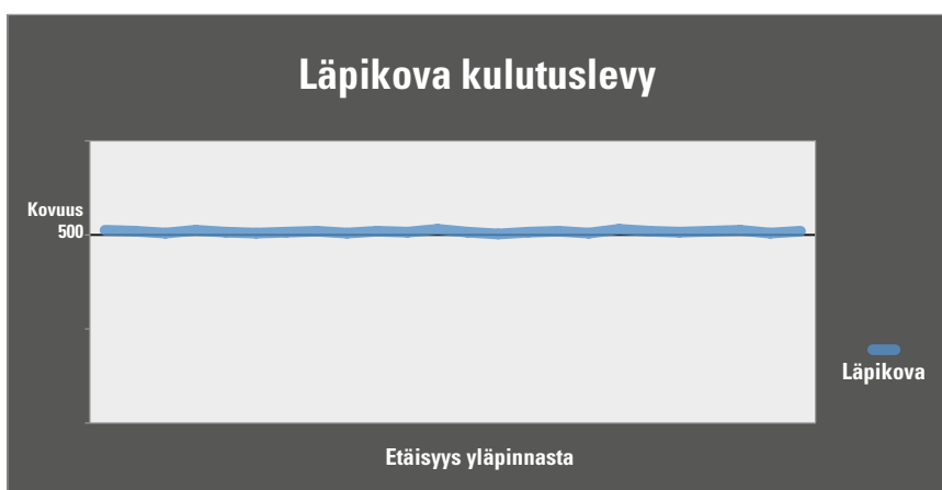
Kuva 4: Läpikovan levyn kovuuskäyrä. Levy on kovaa pinnasta pohjaan.
