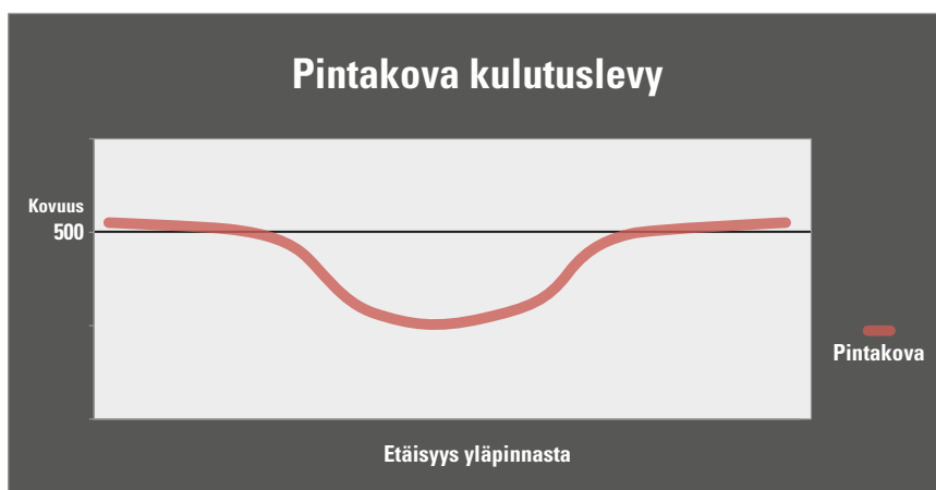
Kuva 3: Pintakovan levyn kovuuskäyrä. Levy on pehmeätä keskeltä.
